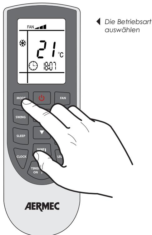
temperatur über dem eingestellten Sollwert liegt, läuft das Gerät so lange, bis die Temperatur im Raum wieder unter den Sollwert fällt.
