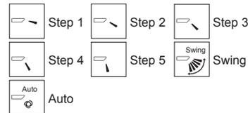
Wählen Sie „Swing“, damit sich die Flügel automatisch auf und ab bewegen. Wenn Sie „Step 1“ (Stufe 1) bis „Step 5“ (Stufe 5) wählen, werden die Flügel in der gewählten Position fixiert.
