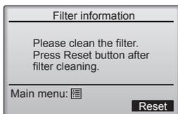
Drücken Sie [F4], um das Filtersymbol zurück zu setzen. Hinweise zur Filterreinigung finden Sie in der Betriebsanleitung der Innenanlage.
