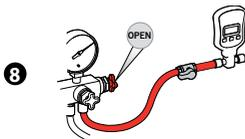
**8** Um auch die rote Leitung, die an das elektronische Vakuummeter angeschlossen ist, unter Vakuum zu setzen, auch den roten Hahn mit der Aufschrift „HIGH“ der Druckmessergruppe öffnen.
