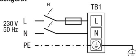
Das Außengerät wird an die Spannungsversorgung mit L, N und PE an **TB1** angeschlossen.
