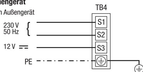
Die Spannungsversorgung des Innengerätes erfolgt durch das Außengerät.
