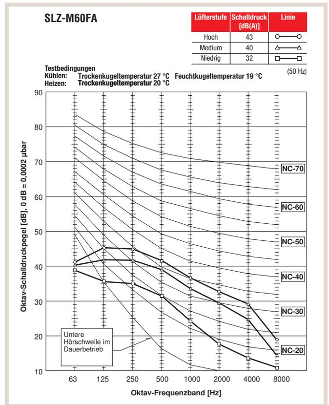
Schalldruckpegel beim Innengerät gemessen mittig in 1,5 m Entfernung unterhalb des Gerätes im Kühlbetrieb
